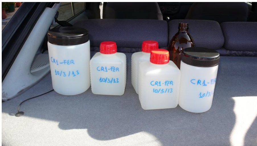
Ilustración 1: Envases para la toma de muestras en el rebosadero de la caja de captación de Ferrás
